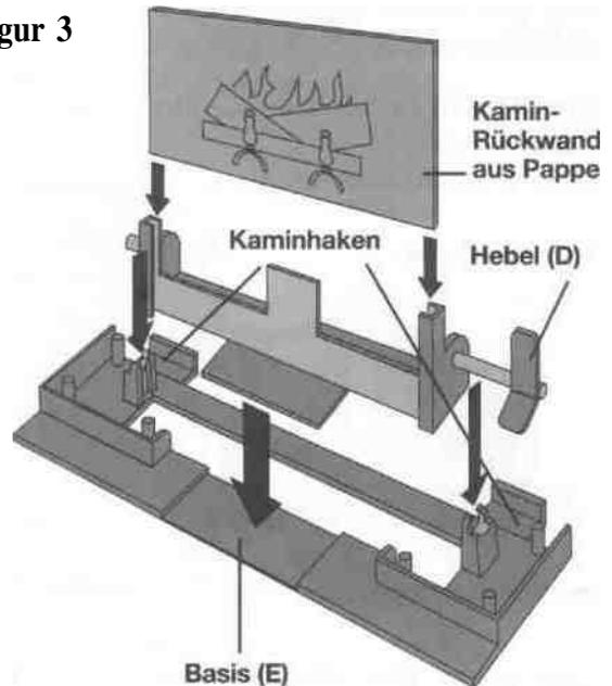
Der Pappkamin wird vorsichtig entlang der Falze geknickt und mit dem Hebelmechanismus in die Aussparung der Basis eingesetzt. Dann wird das Kaminsims (F) oben aufgesetzt. Siehe Figur 3A.
